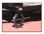
LEVELING JACKS ARE MOUNTED ON ALL FOUR CORNERS OF THE DECK TO STABILIZE THE TRAILER DURING OPERATION
