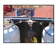
COMPLETE PROPANE SYSTEM IS INSTALLED ON THE TRAILER FROM 2, 25 GAL TANKS TO THE BOILER
