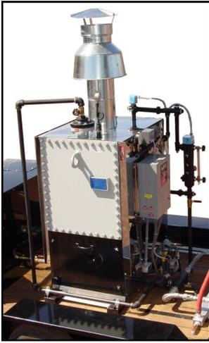
**A STEAM BOILER IS REQUIRED FOR OPERATION OF THE NEWHOUSE ESSENTIAL OIL STILL**
