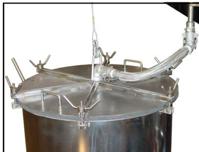
**3/16" S.S. PLATE LID IS SECURED DOWN TO THE COOKER POT WITH 6 SCREW DOWN CLAMPS**
